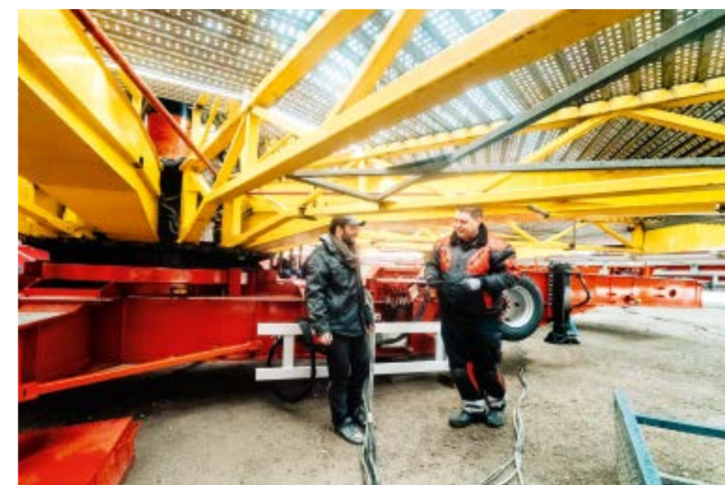
»„Die gesamte Anlage steht auf hydraulisch betriebenen Stützen“, erklärt Vespermann. »„The entire installation stands on hydraulically operated supports“, explains Vespermann.
