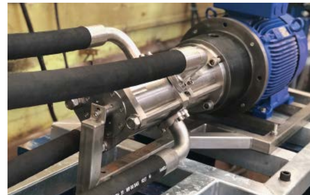
» Die Hochdruckpumpe Salino®: Die Besonderheiten des Projekts lagen nicht im Schlauch, sondern in der Verbindung. » The Salino® high-pressure pump: what was special about the project was not the hose but the connection.
