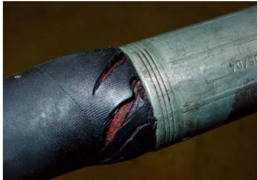
» Aufgeplatzte Schlauchleitung durch Torsionsbeanspruchung. » Burst hose line due to torsional stress.
