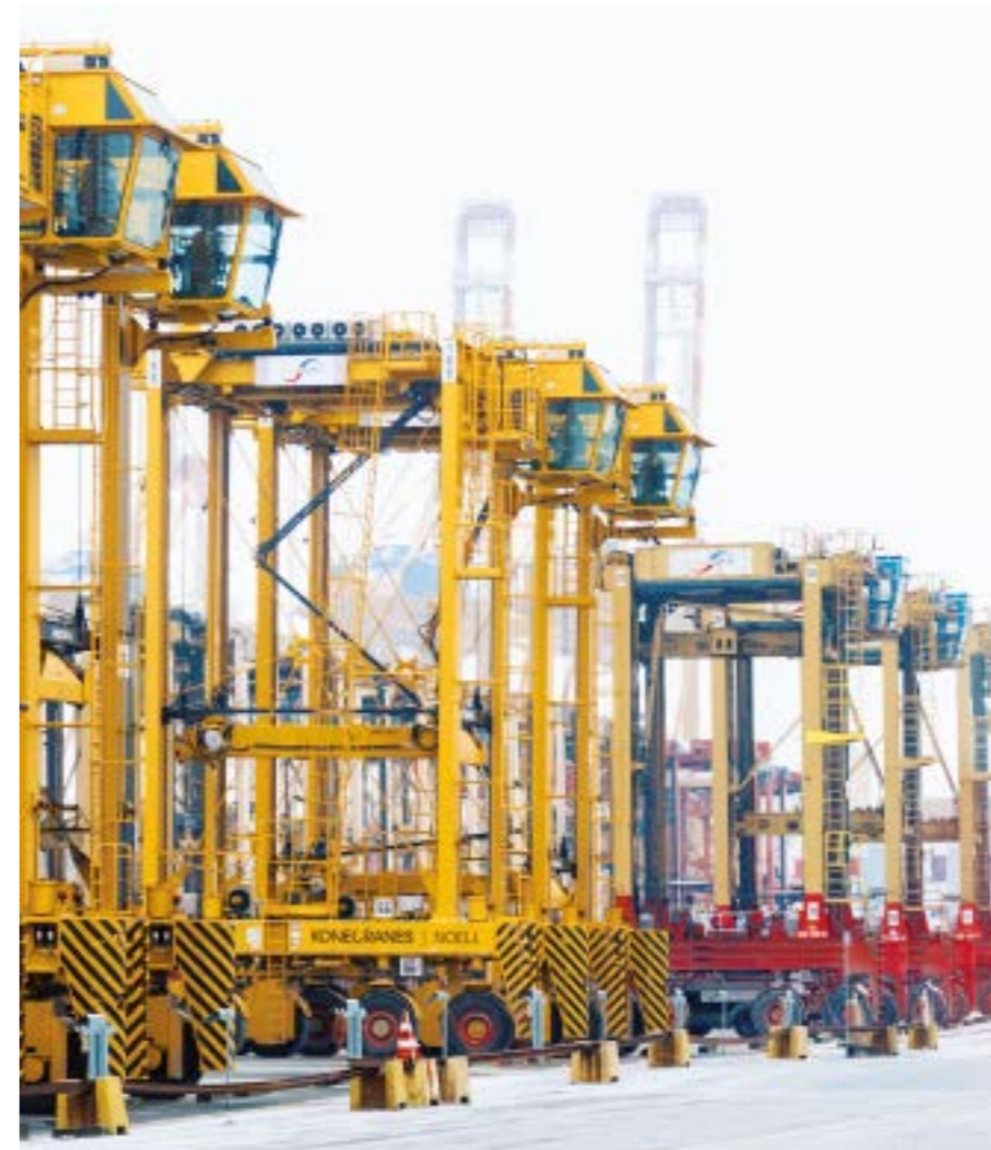
» Allein in Bremerhaven setzt Eurogate für den Containertransport an Land rund 230 Portalhubwagen ein. » In Bremerhaven alone Eurogate uses around 230 straddle carriers for transporting containers on land.
