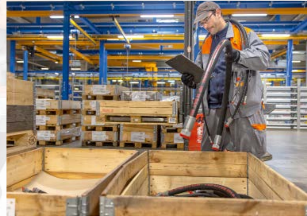
» 8.000 Hydraulikschlauchleitungen werden pro Woche für Hamm gefertigt – sie sind bereits maschinenbezogen kommissioniert und entsprechend der Arbeitsgänge in der Vor- und Taktmontage als Kit zusammengestellt.
