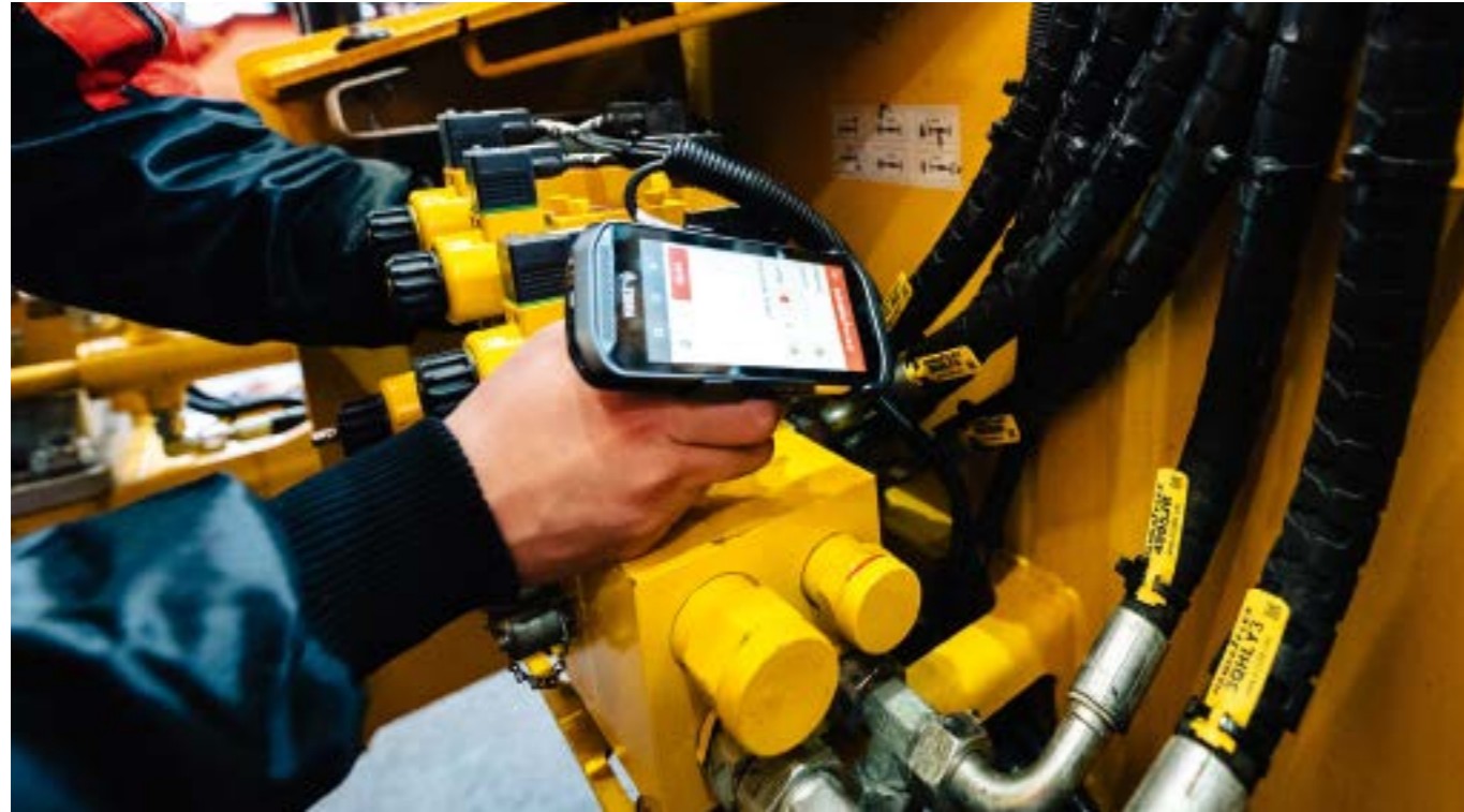
» Das Label an den Leitungen enthält den X-CODE nicht nur schriftlich, sondern auch digital auf einem RFID-Chip mit HF-Technologie. Diese erlaubt nur kurze Auslesedistanzen von wenigen Zentimetern. » The label on the hose not only contains the X-CODE in writing, but also digitally on an RFID chip. This allows only short read-out distances of a few centimetres.
