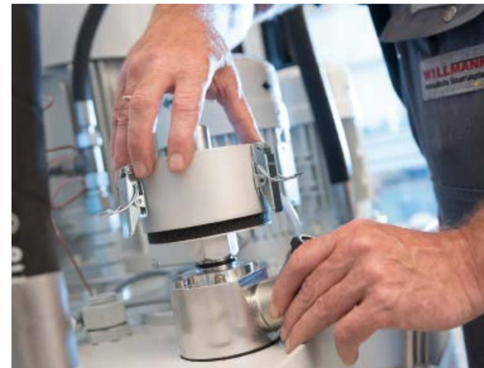
» Adsorberfilter werden auf die Belüftungsöffnung eines Tanks montiert und ersetzen dort den herkömmlichen Belüftungsfiter.
