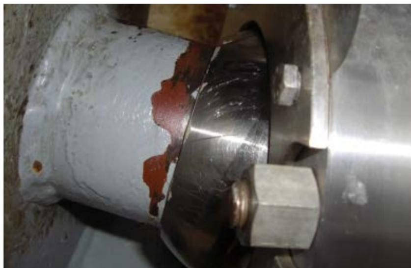
» Das elastomere KDS dichtet das System auch bei gealterten, leicht beschädigten Kugeloberflächen ab.
