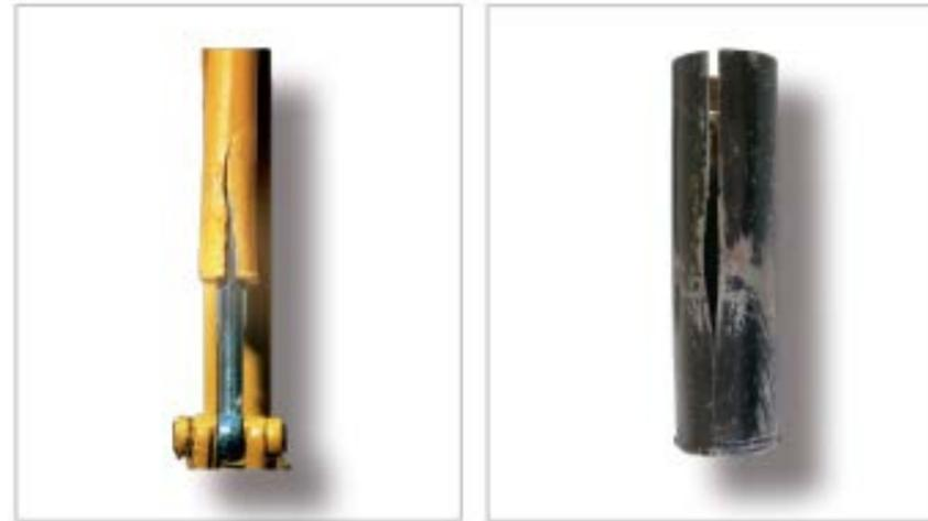
Bei Hydromotoren und Wegeventilen besteht die Gefahr der Druckübersetzung nicht, aber auch hier können zu hohe Rücklaufdrücke die Komponenten beschädigen.
