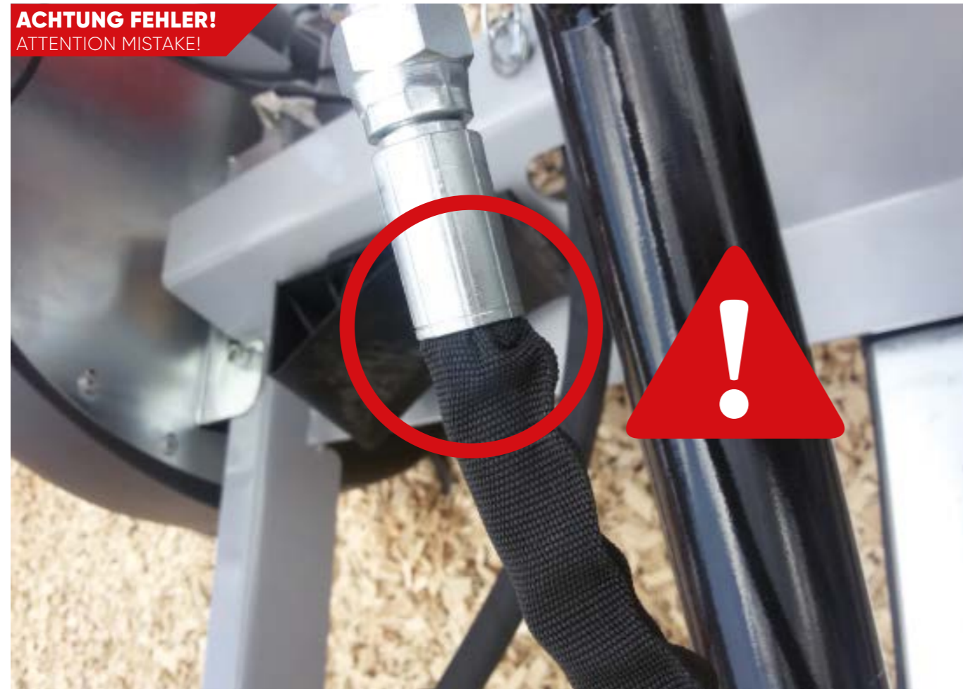
» Das Einbinden des Schutzschlauches mit der Hydraulikschlaucharmatur ist nicht zulässig. » The protective hose must not be connected to the hydraulic hose fitting.
