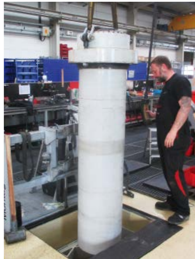
» Seit Neuestem ist in der Werkstatt ein Montageloch eingebaut, das die senkrechte Montage und Demontage von Zylindern erlaubt.
