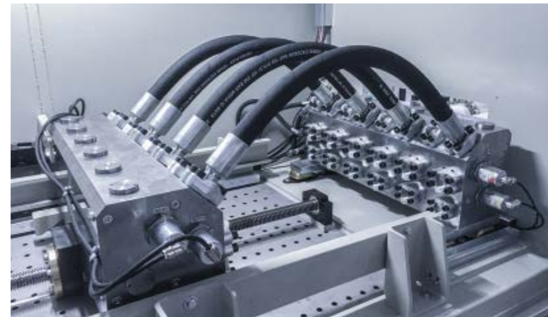
◀ Prüfkammer für Druckimpuls- prüfungen ohne Biegung von Hydraulikschlauchleitungen.
