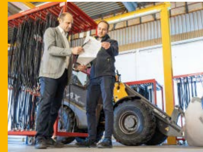
Damit bei der Serienfertigung die Teileversorgung nicht abreißt, setzt Mecalac auf ein Kanban-Lager, das mit Schlauchleitungen, Rohrleitungen, Kupplungen und Verschraubungen bestückt ist.
