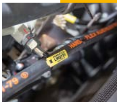
Die Kompaktlader stellen hohe Anforderungen an die Hydraulikschlauchleitungen. Es gelang, die Biegeradien zu optimieren, ohne den Durchfluss im Hydraulikkreislauf zu behindern.
