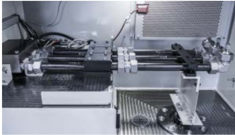
Prüfkammer für Druckimpuls-/Vibrations-Prüfungen von Rohrverschraubungen.
