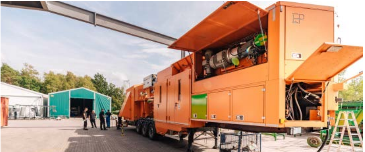
▲ Trailermobile Kanalballen- presse – eingehaust und abgedichtet zur Vermeidung von Faserflug.
