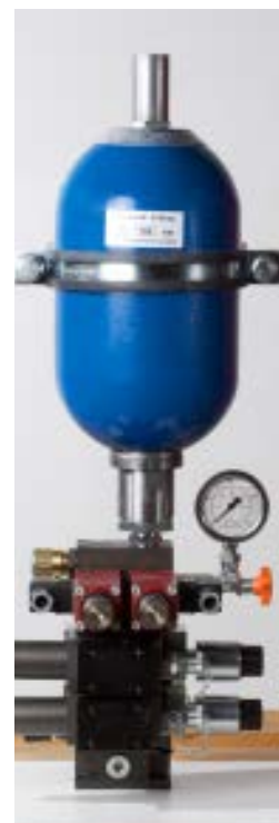
Arbeiten an Druckspeichern dürfen nur fachkundige Personen durchführen, die speziell dafür geschult wurden.
