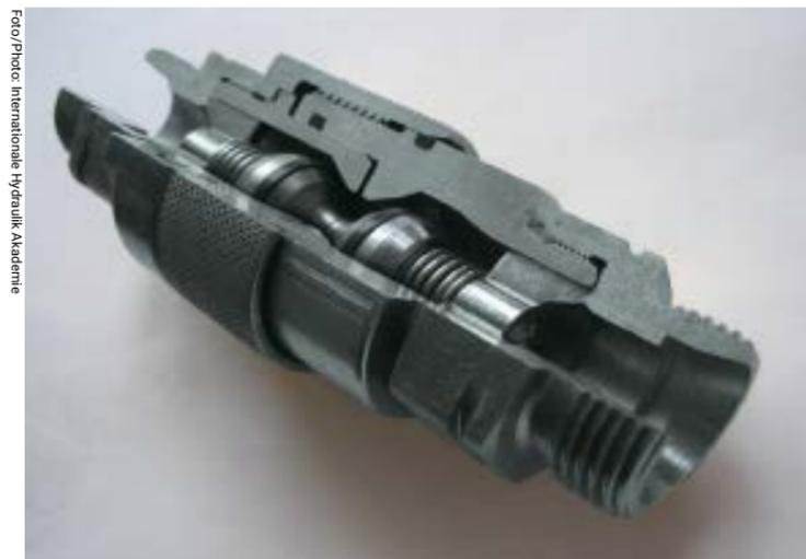
Abb. 3: Schnittbild – Schraubkupplung nicht 100 % verschraubt.
