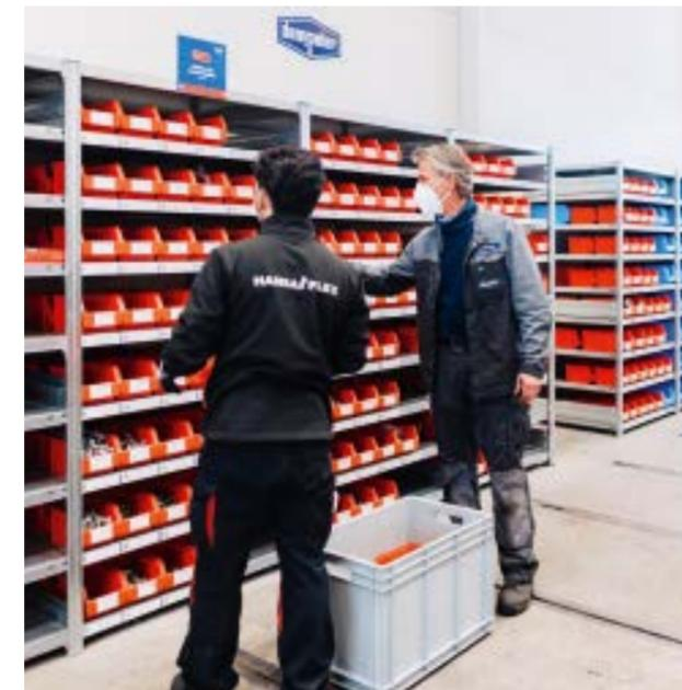
Damit es während des eng getakteten Fertigungsprozesses nicht zu unvorhergesehenen Stillständen kommt, setzt Demmeler auf das Know-how von HANSA-FLEX in der Logistik. Mit einem Zwei-Behälter-Kanban-System sorgt HANSA-FLEX für eine optimale Teileverfügbarkeit.
