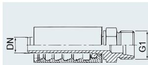
Pressarmatur Typ PAY, CES, schwere Baureihe, Überwurfmutter, gerade, Stahl
