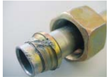
Auch dieser Schaden ist durch eine SRWD Dichtung wieder behoben worden.
